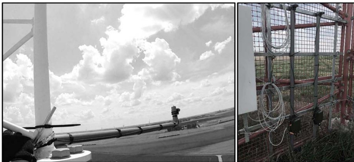
FIGURE 52 – ENREGISTREURS AUTOMATIQUES EQUIPANT LE MAT DE MESURES DU MOULIN D'EMANVILLE, SM4BAT FS AVEC MICRO SMM-U2 A DIFFERENTES HAUTEURS (SOURCE : ING ENVIRONNEMENT)
