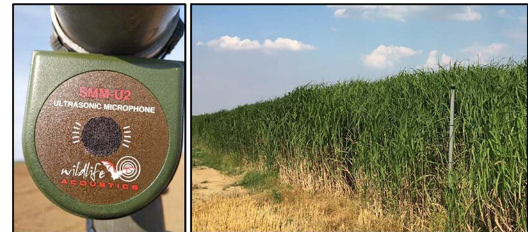
FIGURE 51- ENREGISTREUR SM4BAT FS AVEC UN MICRO SMM-U2 EN CONFIGURATION D'ECOUTE SEMI-PASSIVE SUR PERCHE DE 2M AU NIVEAU DU POINT D'ECOUTE C4 (SOURCE : ING ENVIRONNEMENT)
